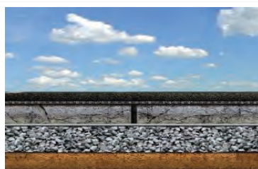
Sanierung von Betonflächen mit Asphalt
